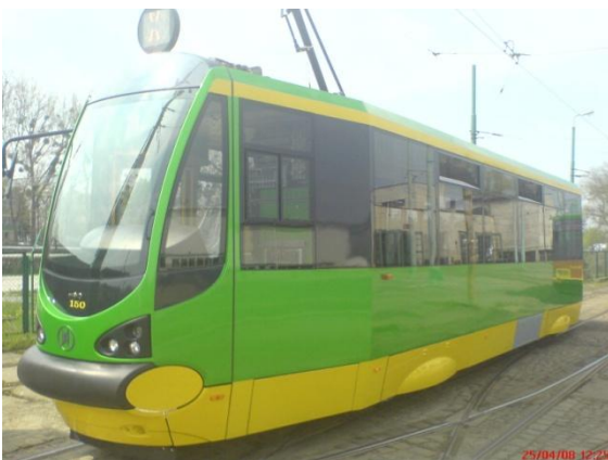
Tramwaj Moderus ALFA wyposażony w napęd asynchroniczny ENI-ZNAP-105N, w Poznaniu
