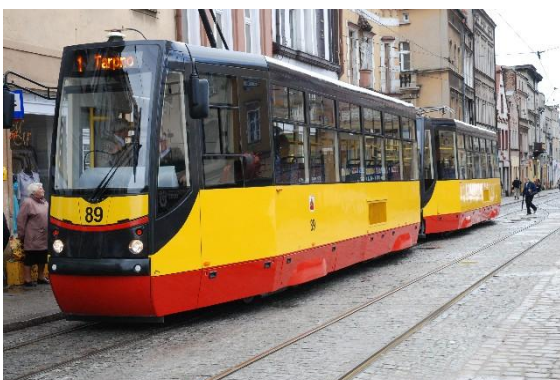
Tramwaj rodziny 105N wyposażony w napęd asynchroniczny ENI-ZNAP-105N, w Grudziądzu
