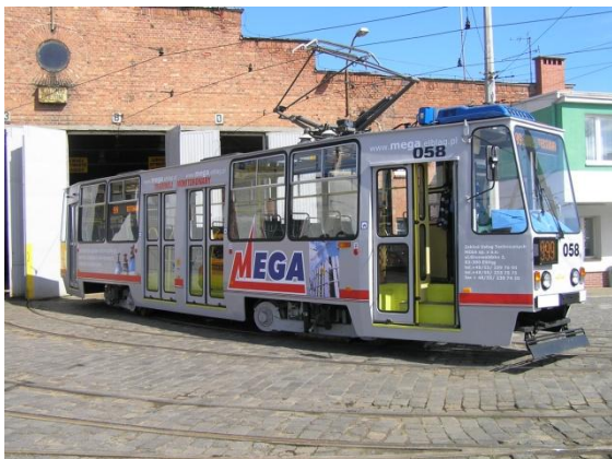
Tramwaj rodziny 105N wyposażony w napęd asynchroniczny ENI-ZNAP-105N, w Elblągu
