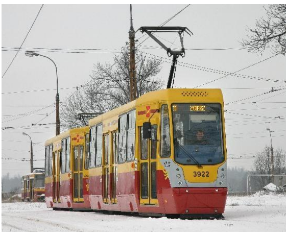
Tramwaj rodziny 105N wyposażony w napęd asynchroniczny ENI-ZNAP-105N, w Łodzi
